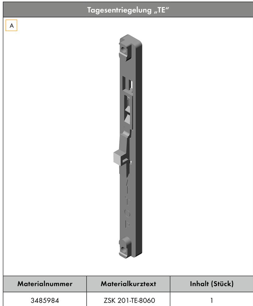
An allen Mehrfachverriegelungen AS 3500 mit der Zusatzbezeichnung „T0“ ist eine separat erhältliche Tagesentriegelung nachrüstbar. Diese deaktiviert die Automatikfunktion, d.h. nach Aktivierung werden die Schwenkhaken nicht mehr ausgelöst.
