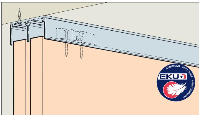
**System: Laufschiene untenlaufend, für 1 Holztüre bis 80 kg**
