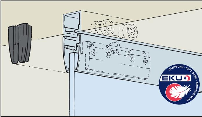
**System: Standard-Laufschiene, deckenbündige Montage, für 1 Glastüre bis 100kg.**
