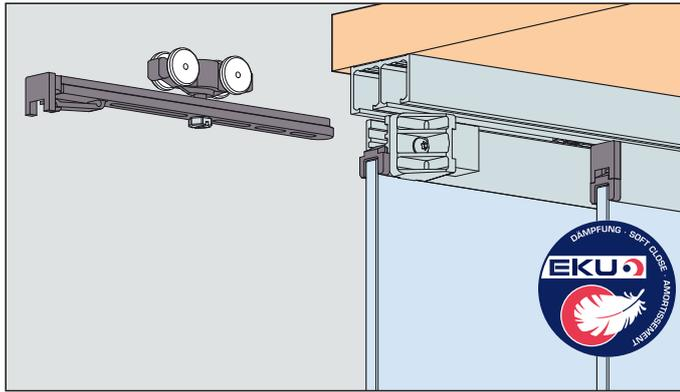
**System: Laufschiene eingenetet oder aufgeschraubt, keine Nut im Boden, ohne Blende, mit verdecktem Clip-Laufwerk, für 2 Glastüren bis 16 kg. Design Alu-Glasfixierungsprofil 12/20 mm – Inslide**
