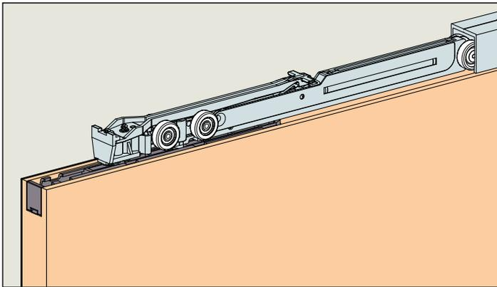
**System: Einzugsdämpfung, bis zu 60 oder 100kg, für leisen und sanften Schiebekomfort, bei obenlaufenden Holztüren für EKU-PORTA 60/100 Holz Systeme.**
