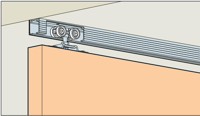
**System: Laufschiene für Decken- oder Wandmontage, für 1 Holztüre bis 45 kg.**
