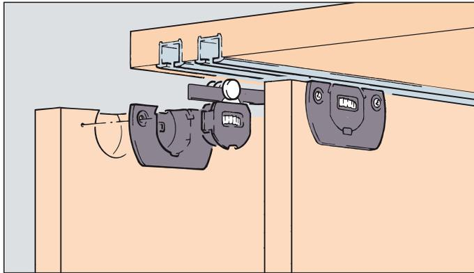
**System: Laufschiene eingetütet oder aufgeschraubt, keine Nut im Boden, ohne Blende, Clip-Laufwerk mit Finger-Justierrad, für 2 Holztüren bis 15 kg. Design Inslide**
