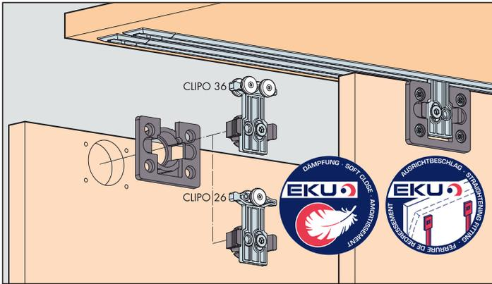
**System: Laufschiene eingetütet, keine Nut im Boden, ohne Blende, mit Clip-Laufwerk, für 2-3 Holztüren bis 26/36 kg. Design Inslide**
