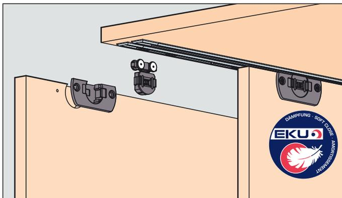
**System: Laufschiene eingenetet, keine Nut im Boden, ohne Blende, Clip-Laufwerk mit Finger-Justierrad, für 2 Holztüren bis 16 kg. Design Mixslide**
