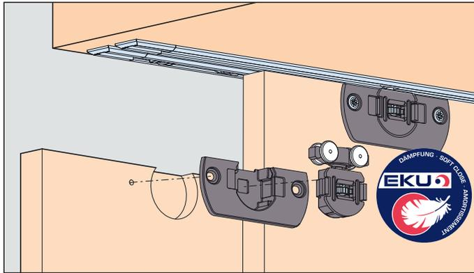
**System: Laufschiene eingenetet oder aufgeschraubt, keine Nut im Boden, ohne Blende, Clip-Laufwerk mit Finger-Justierrad, für 2 Holztüren bis 16 kg. Design Inslide/Mixslide**
