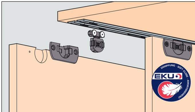
**System: Laufschiene eingenetet oder aufgeschraubt, keine Nut im Boden, ohne Blende, Clip-Laufwerk mit Finger-Justierrad, für 2 Holztüren bis 16 kg. Design Inslide**
