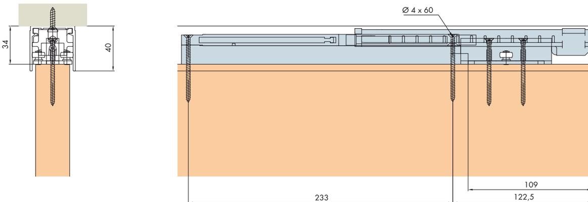
**Dämpfen in Schliessrichtung / Soft closing in closing direction / Amortissement dans le sens de fermeture**
