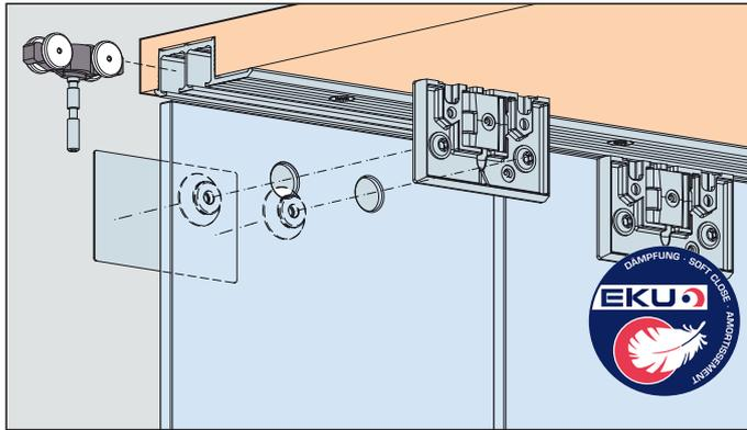
**System: Laufschiene eingenetet oder aufgeschraubt, keine Nut im Boden, ohne Blende, Laufwerk geschraubt, für 2 Glastüren bis 16 kg. Design Inslide**
