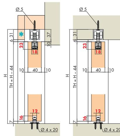
\* Für das Ein- und Ausschwenken darf eine Blende bis max. an die Unterkante der Schiene reichen.
