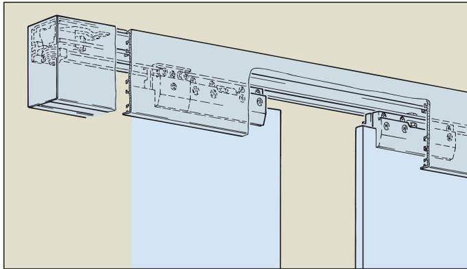
**Systemzusatz: Synchro für 2 synchronlaufende Glastüren mit Kevlarseil zu EKU-PORTA 100 G**
