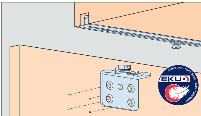
**System: Laufschiene eingenetet, keine Nut im Boden, ohne Blende, Laufwerk mit Clip, für 1 Holztüre bis 16 kg. Design Forslide**
