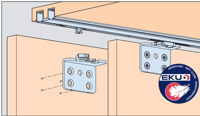
**System: Laufschiene eingenetet oder aufgeschraubt, keine Nut im Boden, ohne Blende, Laufwerk mit Clip, für 2 Holztüren bis 16 kg. Design Inslide/Forslide**
