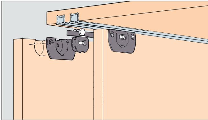
**System: Laufschiene eingenetet oder aufgeschraubt, keine Nut im Boden, ohne Blende, Clip-Laufwerk mit Finger-Justierrad, für 2 Holztüren bis 15 kg. Design Mixslide**
