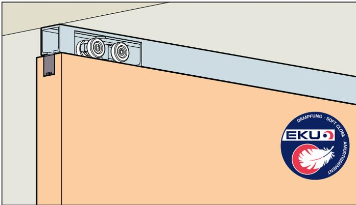
**System: Laufschiene für Deckenmontage, Einbauhöhe 31 mm, einsetzbar aufgesetzt oder deckenbündig, für 1 Holztüre bis 60/100 kg.**
