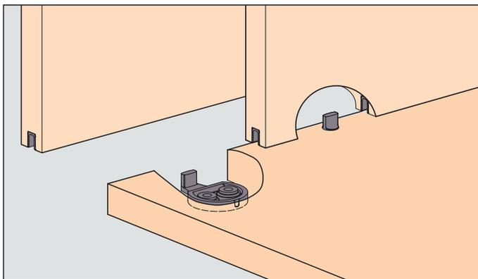
**Bei zurückversetzter Seitenwand Stopper/Türmitnehmer unten setzen**
