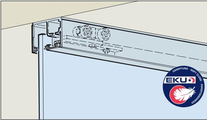
**System: Laufschiene, Einbauhöhe 58 mm, einsetzbar bei aufgesetzter oder deckenbündiger Anwendung, für 1 Glastüre bis 100 kg.**
