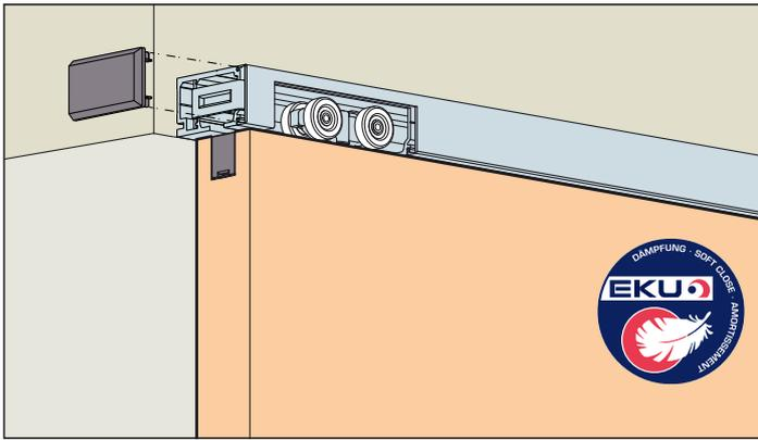
**System: Designlaufschiene für Wandmontage, Einbauhöhe 31mm, für 1 Holztüre bis 60/100 kg.**
