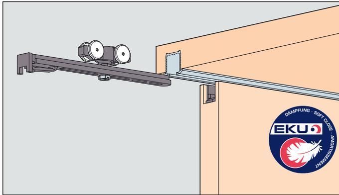
**System: Laufschiene eingenetet, keine Nut im Boden ohne Blende, Clip-Laufwerk für verdeckte Montage, für 1 Holztüre bis 16 kg. Design Inslide**
