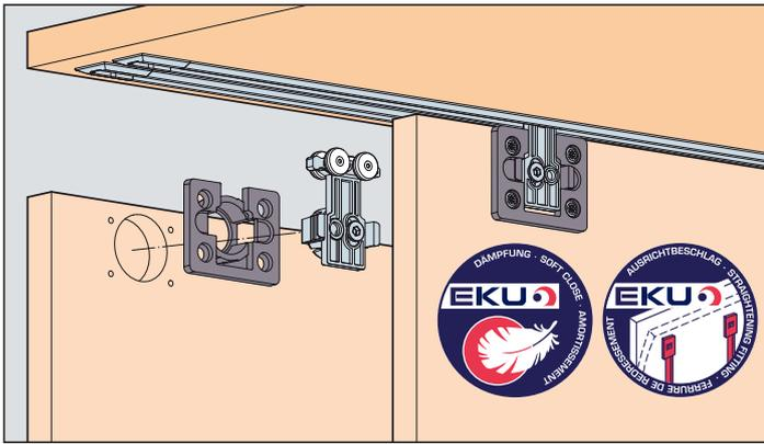
**System: Laufschiene eingetutet, keine Nut im Boden, ohne Blende, mit Clip-Laufwerk, für 2-3 Holztüren bis 36 kg. Design Mixslide**
