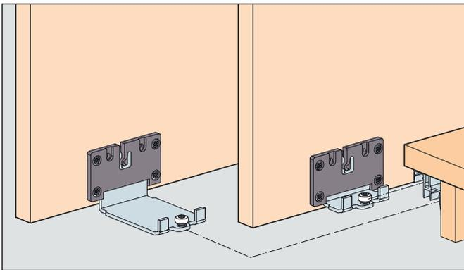
**System: Laufschiene eingetütet, keine Nut im Boden, ohne Blende, mit Clip-Laufwerk, für 2-3 Holztüren bis 26 kg. Design Mixslide**
