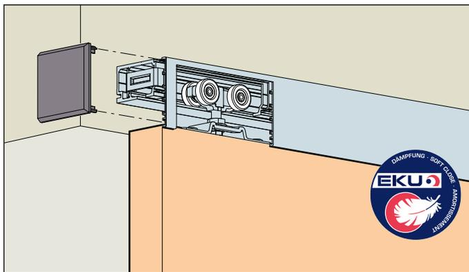
**System: Laufschiene für Wandmontage, für 1 Holztüre bis 60/100 kg.**
