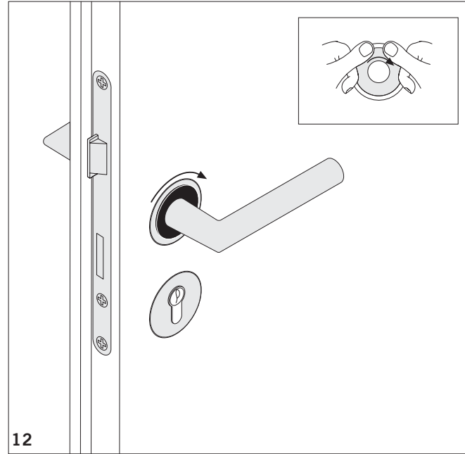
Bild 12 Die Deckrossette mittels Kautschuk-Ringes (Kratzschutz und Mitnahmekupplung) um 45° drehen.
